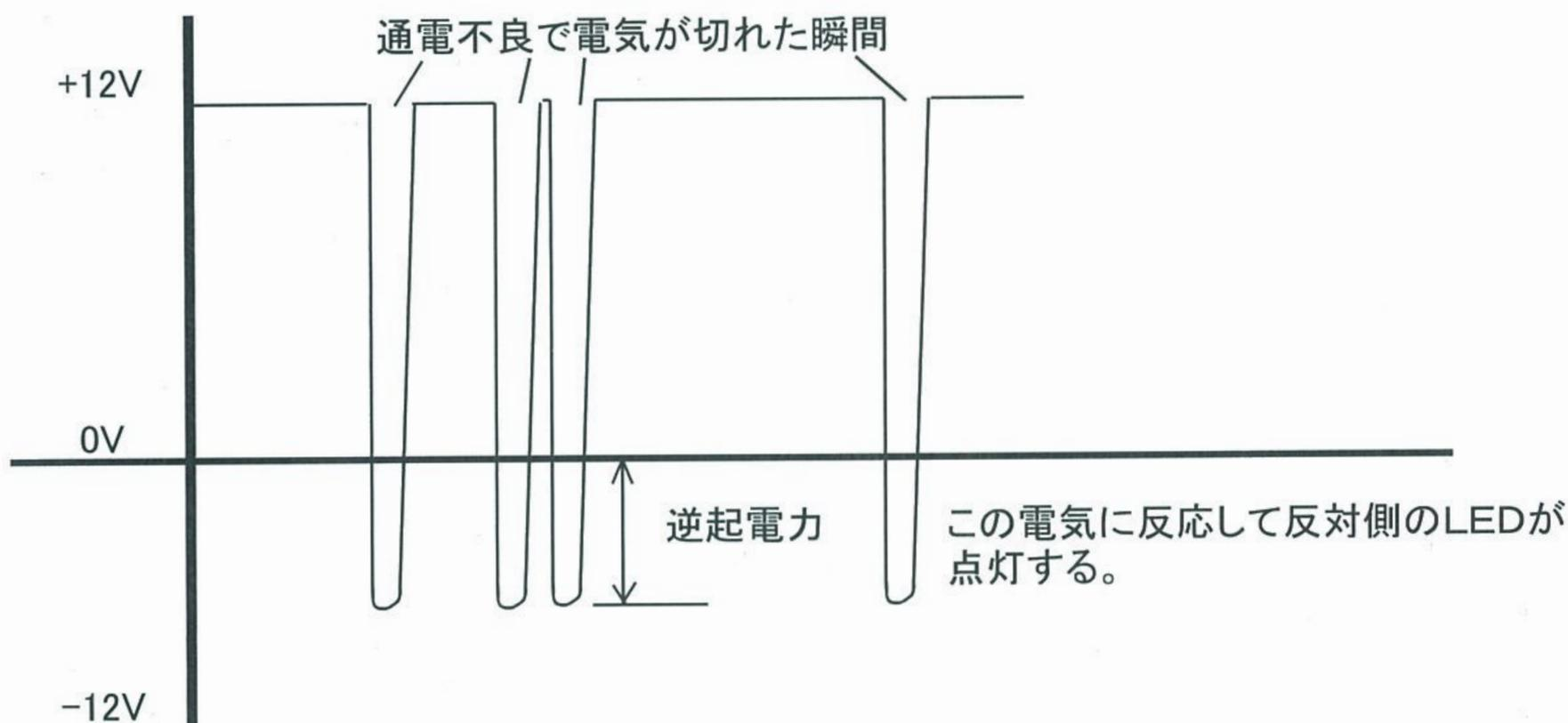
この現象を回避するには発生する逆起電力をコンデンサで吸収してしまう方法がありますが、コンデンサは弊社製品を含めパルス制御の制御機器との相性が非常に悪いいため、基板回路では採用する事が出来ず、LEDならではの電気特性とさせていただいております。
