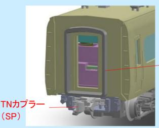
TNカプラー(SP)を標準装備 また、連結面部の幌枠も 新規製作で再現します
