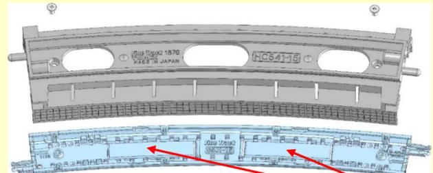
5567 TCSワイドレール・スラブレール用センサーを取り付ける場合はタッピングを外して分解後、レール下面のV溝をカッター等でカットしてセンサー取付穴をあけ、センサーを取り付けて元のように組みなおします。センサーコートは高架橋の3つの穴のいずれかから出します。5567以外のセンサーは取付不可。
