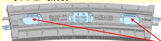
5538 ワイドレール・スラブレール用D.C.フィーダーNを高架橋下側から取り付けて給電可能。(矢印で示す2カ所) 5538以外のフィーダーは取付不可。
