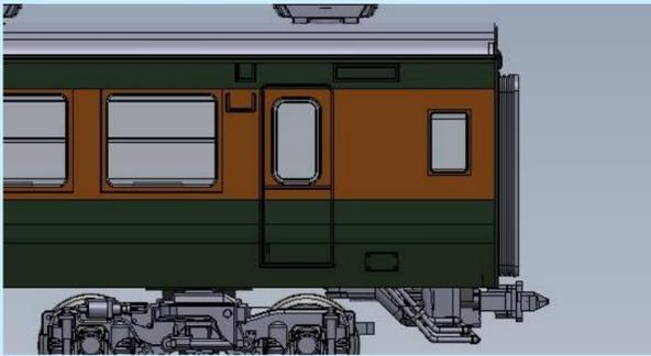
**POINT:2** 各連結面は配管付のTNカプラーを装着 対応するトイレ流し管が取付済み
