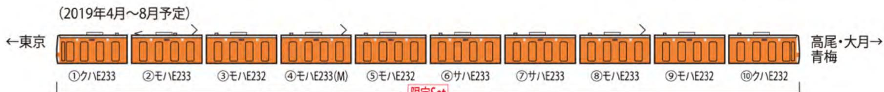
※走行させるレイアウトの条件に合わせて、2号車、または8号車のモハE233形に、別売の〈0642〉動力ユニットFW (DT71A付)を組み込んで、動力化してください。
