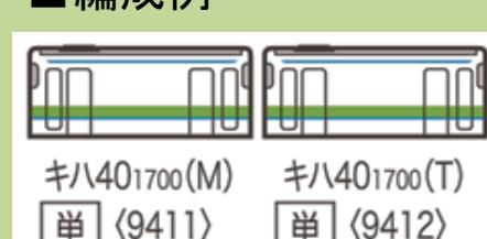
キハ40-1700形はキハ40系の極寒地向け車両キハ40-100のワンマン改造車であるキハ40-700に延命対策を施した車両で、各部補修と共にエンジン、変速機の更新、屋根上水タンクの車内移設が行われ、元車番に1000プラスされました。
