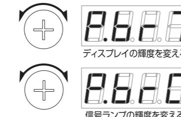
3.1~20の中でお好みの輝度をダイヤルで選択し、「決定」ボタンを押すと設定されます。設定した輝度は電源を切っても記憶されます。
