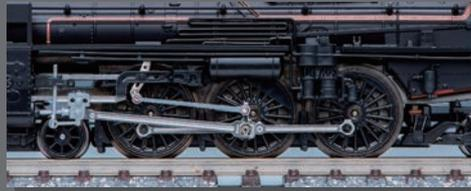
●動輪の変形を防ぐため、輪心周りに「水かき」のヒレのような補強が付いた、同形独自のスポーク動輪をリアルに模し、先台車にはスポークを細く、美感的に再現した車輪を用いています。動輪や先輪以外に、シリンダーやピストン棒、クロスヘッド、主連棒、連結棒などの下回りの他、元空気だめ、コンプレッサー、給水ポンプ(写真反対側)などの各部も見応えのあるものとしています。最小通過カーブ半径は280mmです。
