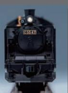
●C55形の特徴である煙室扉付近のエプロン形状に加え、ヘッドライト(電球色LEDにより点灯)横の補助灯(レンズ入り非点灯)、煙室扉横の高い位置にある標識灯など“北海道仕様”の形態を再現、さらに左右の前面ステップが前梁に移された姿としています。写真はダミーカブラーを装着していますが、交換用に重連運転用アーノルドカブラーと自連形TNカブラーを別途用意、さらにフロントデッキ部の手すり、解放テコ、選択式ナンバープレート(C55 43・47・59)を別パーツで付属しています。
