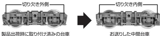
1. 中間台車を下の写真のようにボディに対し90°回転させた状態にしてから、中間台車を引き抜きます。取り外し作業中は、スプリングの紛失にご注意ください。
