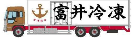
⑥富井冷凍 日野スーパードルフィンプロフィア 冷蔵バン
