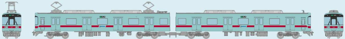
◇西日本鉄道 7000系 主に、甘木～大牟田間のワンマン列車で活躍しています。ワンマン運転時は中央の2扉を締め切り、2扉車として運行されます。
