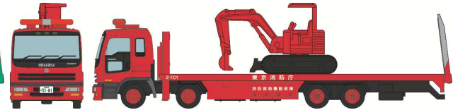
④ 消防庁 いすゞギガ 重機搬送車 (油圧ショベル)
