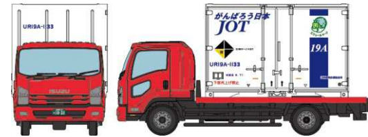
⑥ いすゞフォワード 5tコンテナ車(日本石油輸送 UR19A型コンテナ)
