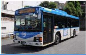
いすゞエルガハイブリッド ノンステップバス 型式:QQG-LV234L3 実車WB:4800mm
