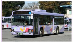
いすゞエルガ ノンステップバス 型式: QPG-LV234N3 実車WB:5300mm
