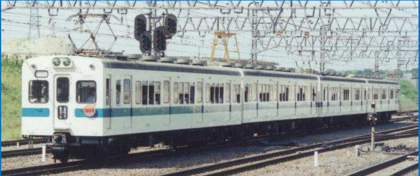
小田急電鉄1800形は、小田急初の大型車となる20m級4扉車として長く活躍した車両です。後には貫通路の広幅化、三段窓の二段上昇窓化が施され、更にノーシル・ノーヘッダーのすっきりとした外観となりました。4両固定編成化された際には、両端の先頭車前面の貫通扉が交換され、貫通扉窓の大型化、方向幕の埋め込み化により、その意匠が変化しました。最大で8両編成を組み、朝ラッシュの急行運用に就く姿も見られました。1981年に最後の編成が廃車となり小田急からは引退しましたが、その後は秩父鉄道に譲渡され活躍を続けました。
