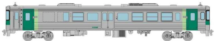
1200型は1500型と併結できるように1000型から改造されたディーゼルカーです。車体色が1500型に合わせて変更されています。
