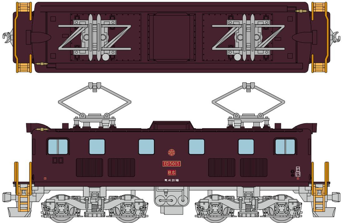
東武鉄道ED5010形は1957から1962年に合計14両製造され、東武鉄道に在籍した電気機関車で、最も数量の多い形式です。坂戸機関区と杉戸機関区に所属し、東上線および本線系統の貨物列車の牽引に活躍しました。製品のプロトタイプは前期型で、後期型と比べて側面のルーバー数が多く、前面ガラスの高さが低いのが特徴です。製品のED5015号機は坂戸機関区に在籍した車両で、東上線系統で活躍した車両です。なお、この5015号機は、墨田区の東武博物館にて保存・展示されております。別売りパーツの動力ユニットはTM-ED01を、走行用パーツセットはTT-05を、パンタグラフは<0238>PG16を推奨しています。
