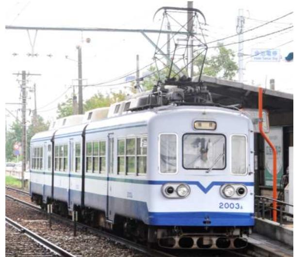
筑豊電気鉄道(株)は北九州市の副都心・黒崎から中間市を経て直方市を結ぶ西鉄グループの鉄道会社。西日本鉄道(株)の福岡市内線と北九州線で活躍していた1000形を筑豊電気鉄道(株)が購入。2両連接車から3両連接車へ改造し、1977年に2000形として運行開始。最盛期に7編成在籍していた2000形のうち、今回は現役で活躍中の2003号と方向幕が大きな2006号を製品化。別売りパーツの動力ユニットは新製品のTM-TR06を推奨しています。本体パッケージサイズ(予定) 65×170×40 (mm)
