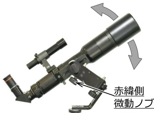
高さ方向の微調整は赤緯側微動ノブを回転させてください。
