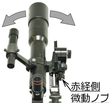
回転方向の微調整は赤経側微動ノブを回転させてください。
