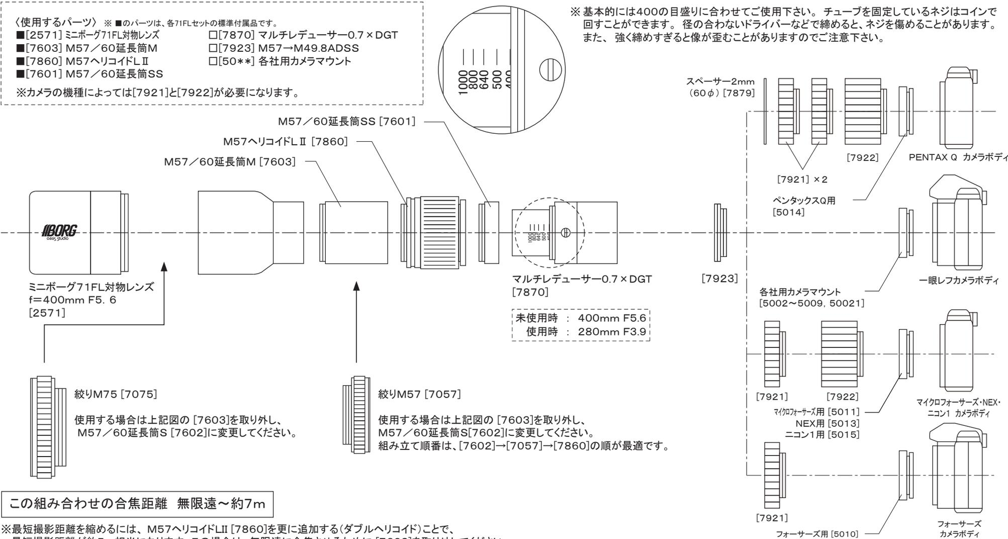
※基本的には400の目盛りに合わせてご使用下さい。チューブを固定しているネジはコインで回すことができます。径の合わないドライバーなどで締めると、ネジを傷めることがあります。また、強く締めすぎると像が歪むことがありますのでご注意ください。
