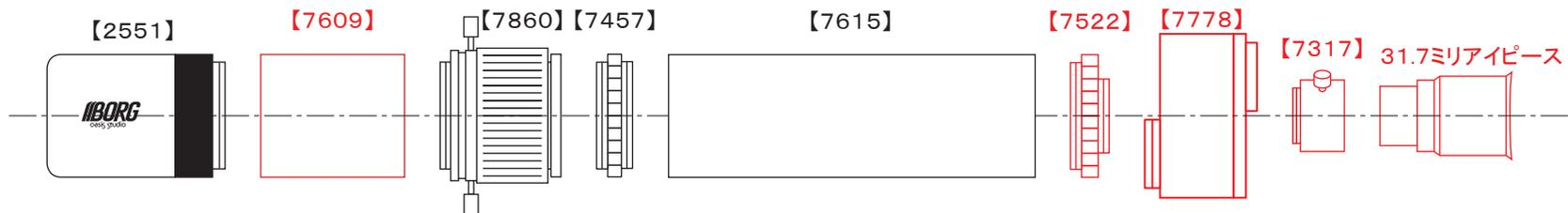
※【7609】を使用することで、無限遠から近距離に合う組み合わせになります。（最短約5m）
