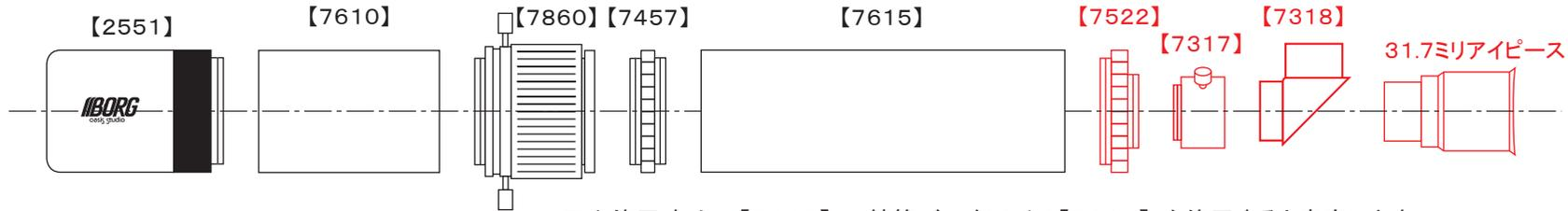
※三脚使用時は、【7615】に鏡筒バンド60φS【7061】を使用すると安定します。
